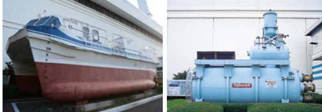
▲半没水型双胴実験船「マリンエース」 ▲超電導電磁推進装置
